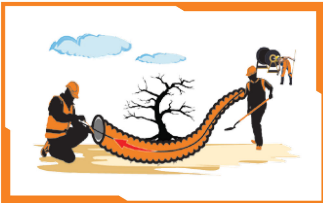
A Luôn cáp dễ dàng, có thể bố trí hố ga ở xa nhau hơn Allows easy cable pull in and permits longer distances between handholes
